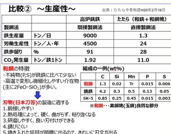
図-4 たたら製鉄法と高炉法の生産性の比較 5)
