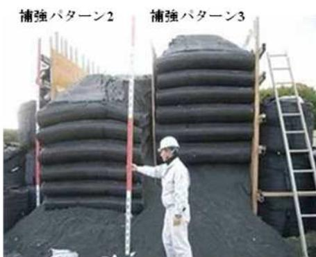
(1) 実物大盛土の静的自重載荷実験
