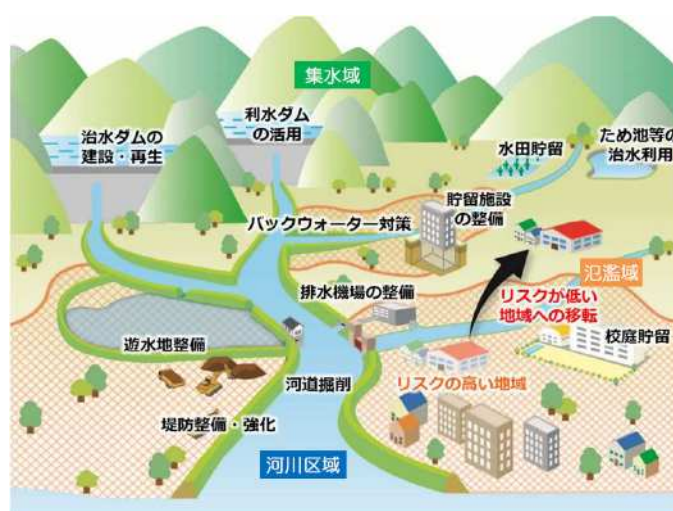
図-2 流域治水の概要図：参考文献4)の抜粋
